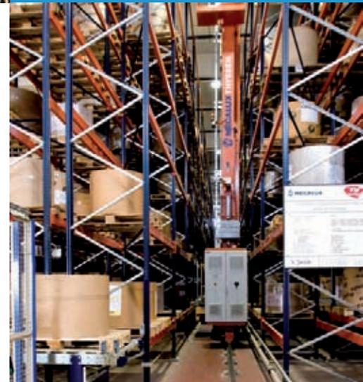
Los transelevadores Mecalux son máquinas de última generación con accionamientos controlados por variadores vectoriales de frecuencia con control de posicionamiento mediante telémetros láser y mando inteligente mediante PC o PLC.
